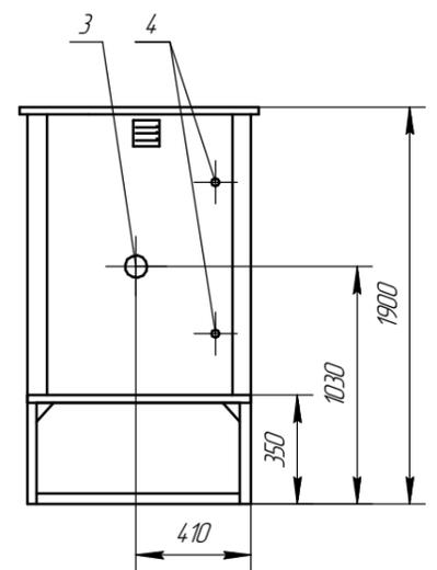
1-входной патрубок (DN32); 2-выход КПС-С (DN20); 3-выходной патрубок (DN50); 4-продувочный патрубок (DN20).
