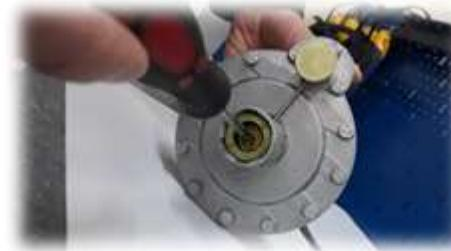
2 Ключ регулировочный 559-01-14 Настройка срабатывания отключающего устройства по повышению (большая гайка)
