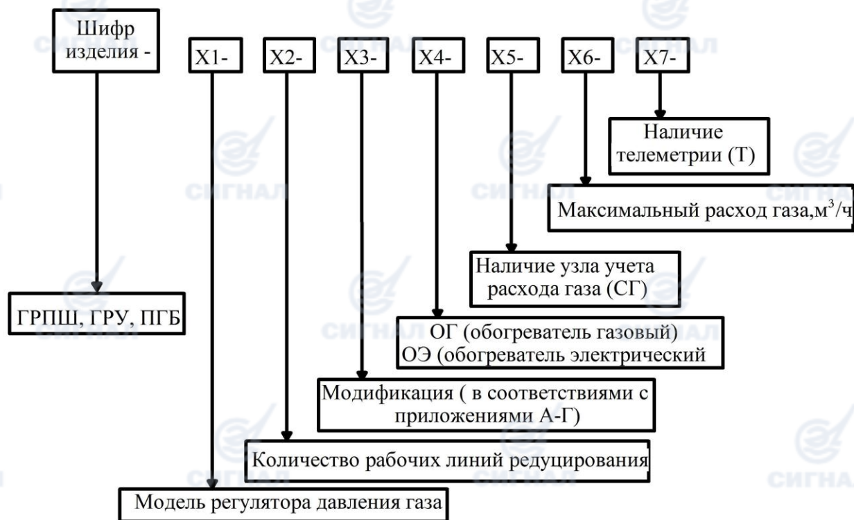
Рисунок 3 - Схема обозначения при заказе ГРПШ, ГРУ, ПГБ
