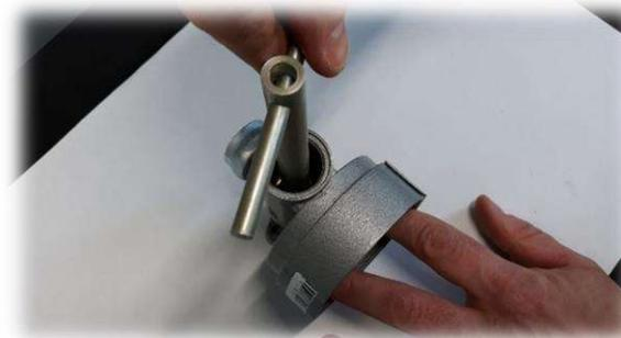
2 Отвертка прямая, шлицевая ГОСТ 17199-88 Установка планки для крепежа рычага в корпусе
