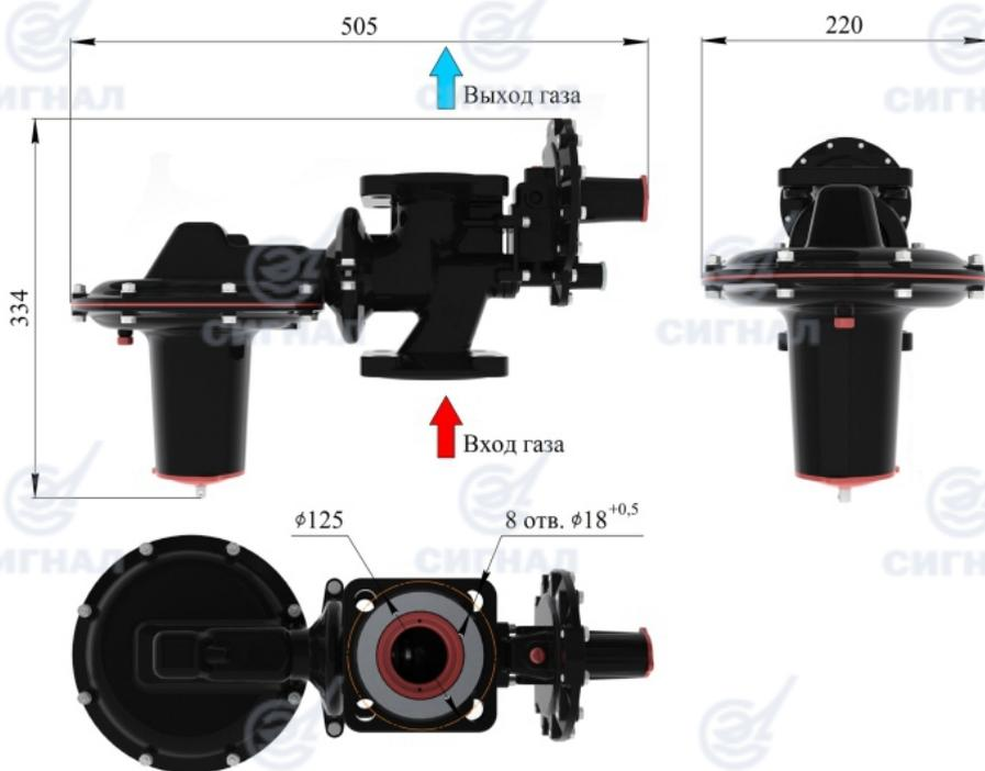
Рис. 7. Соединение фланцевое DN50 по ГОСТ 33259-2015
