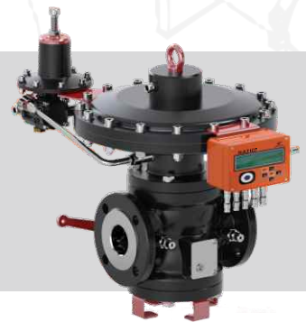
VENIO-C.R5-Z-T Рвх макс = 1,6 МПа, Рвых = 1,5...40 (40...600) кПа, Q макс. = 13 800 м³/ч, DN50/DN50, модульного типа.
