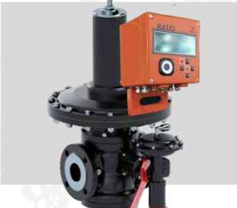
VENIO-B.R1-Z-T Рвх макс = 0,6 МПа, Рвых = 1,5...40 кПа, Q макс. = 1 500 м³/ч, DN50/DN50
