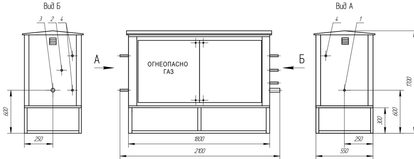
1-входной патрубок (DN20); 2-выходной патрубок сбросного клапана (DN20);
