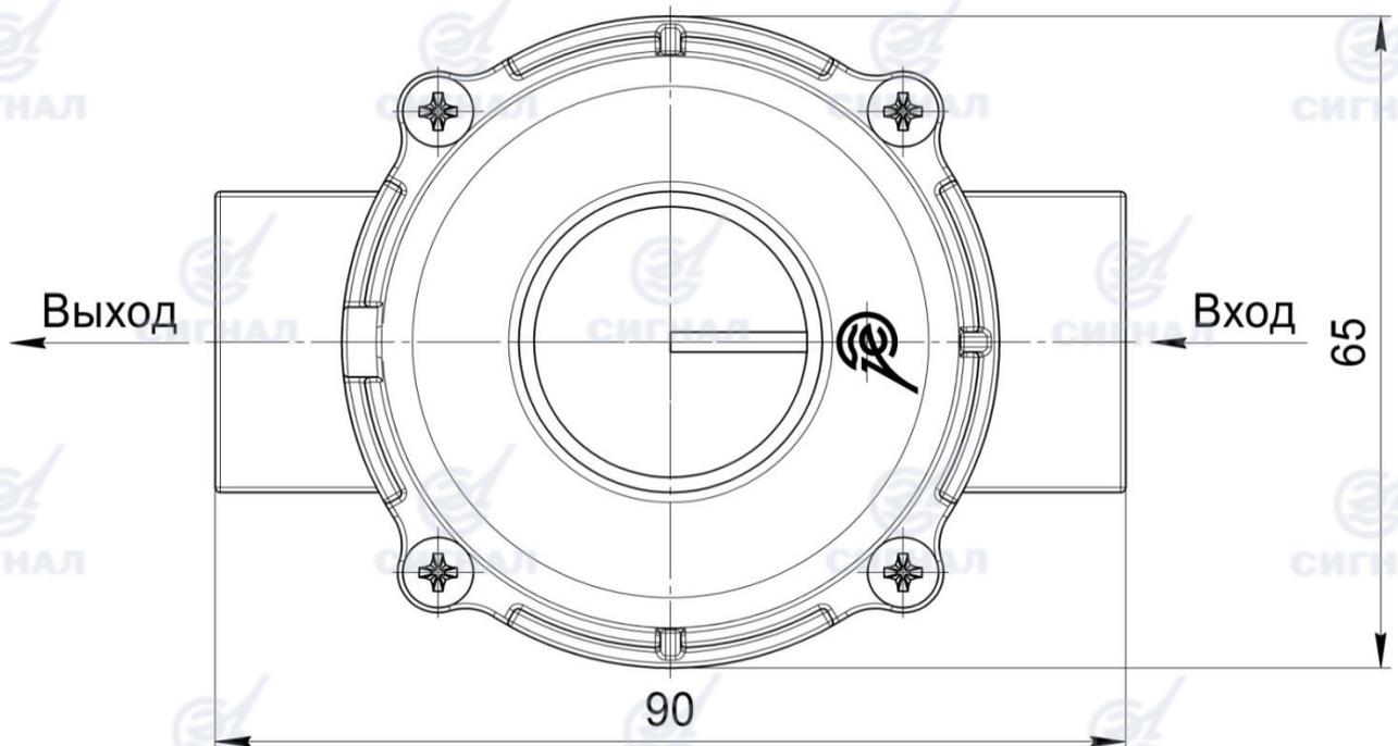
**Рисунок 2 – Габаритная схема стабилизатора**
