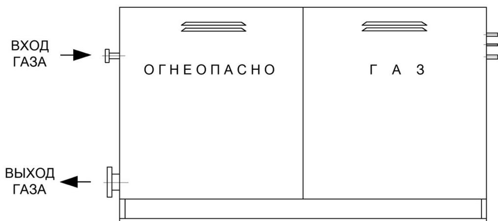
Рисунок 5 – Общий вид ГРПШ исполнение 5
