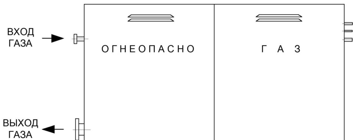
Рисунок 8 – Общий вид ВПРГ исполнение 3
